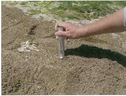
図78 土壌硬度（貫入抵抗）測定
