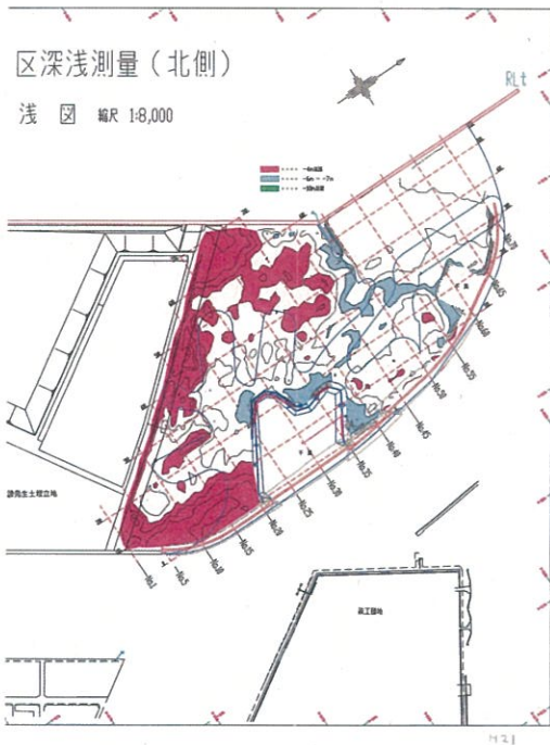
図 102 平成 21 年 北側海域深浅測量図 赤色：-4m 以浅、水色：-6m～-7m
