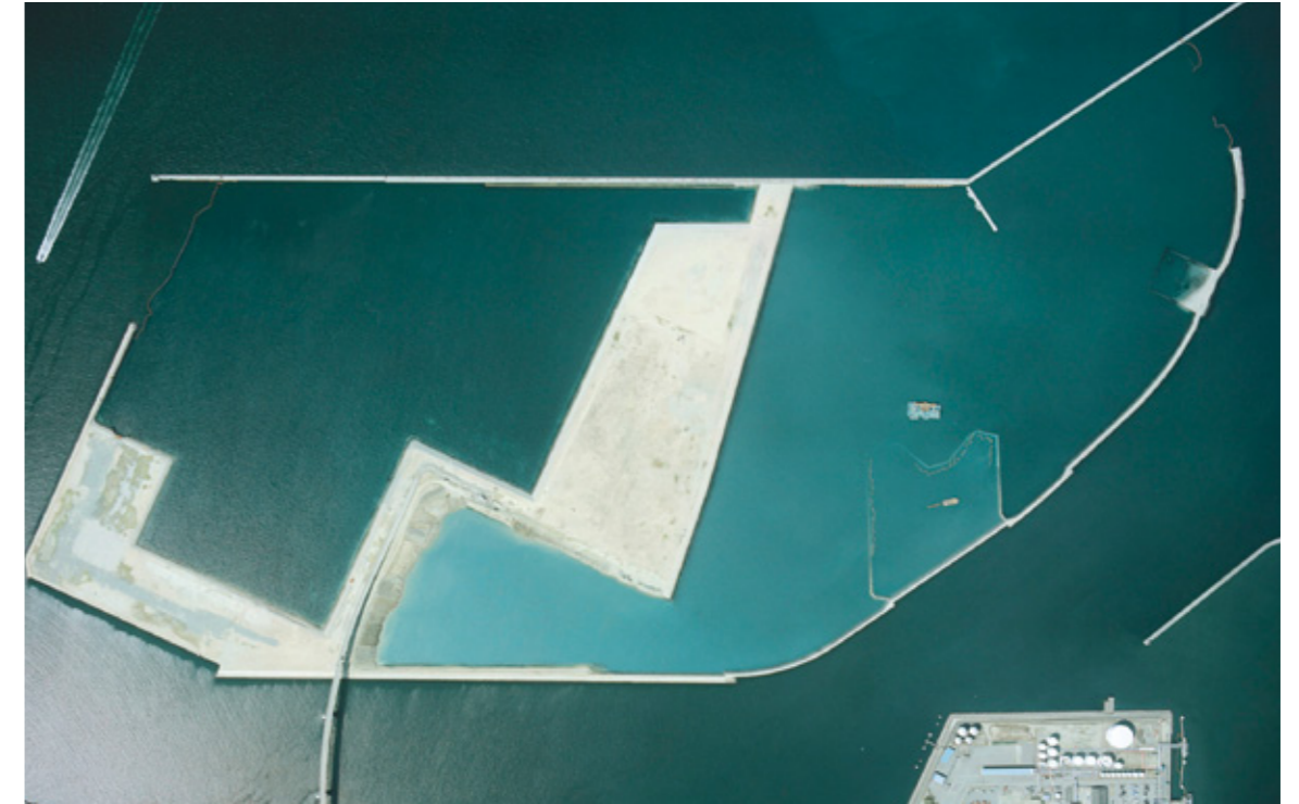
平成15年2月 清掃工場移転用地として早期に造成した第2-2区・第2-3区が、購入土(山土)等を用いて竣功しています。また、岸之浦大橋の暫定供用開始によって、建設発生土は、ダンプトラックによる陸上輸送に変更しています。南干潟(人工干潟)を作るため、干潟周囲の潜堤が築造されています。
