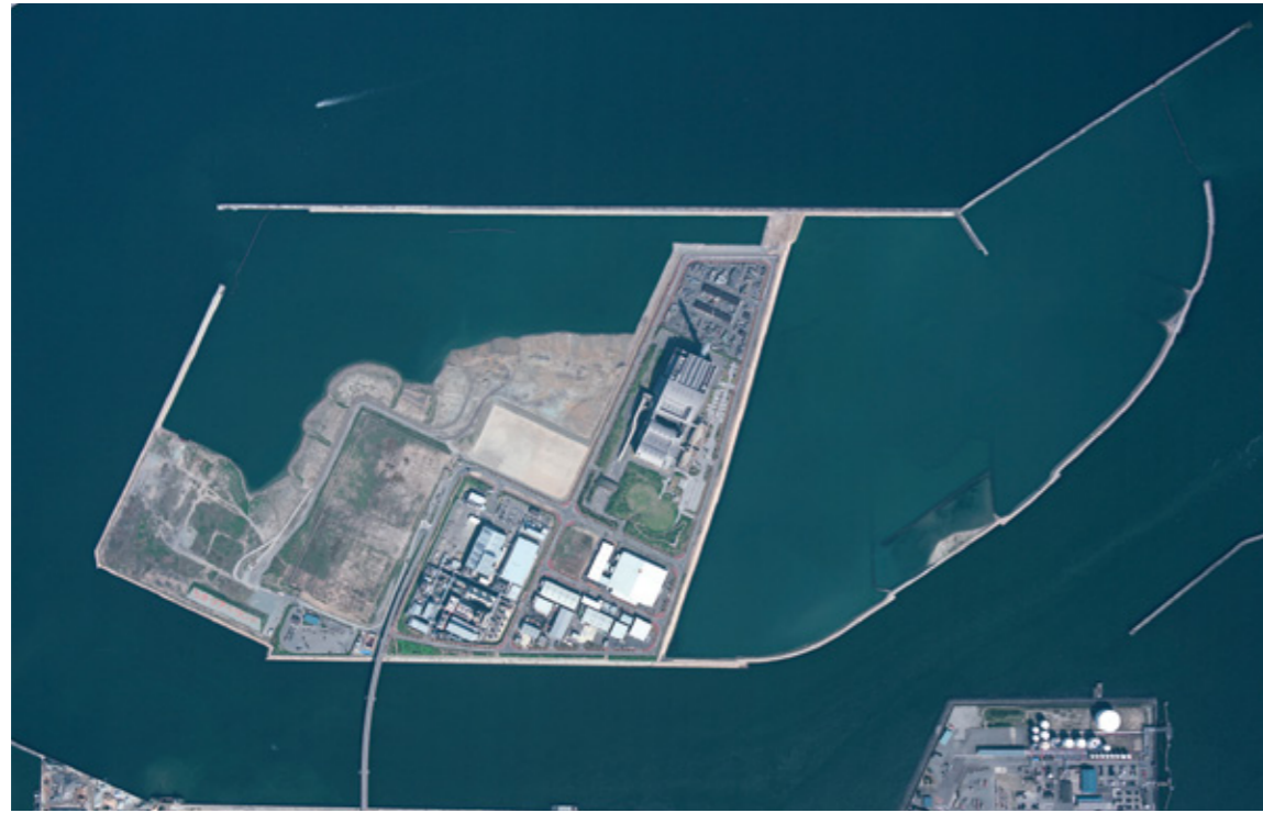
平成24年4月 第5-3-1区(第2期製造業用地)の埋立が進行中で、陸地化した区域(東側)から順次最終覆土が行われています。
